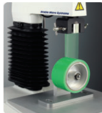
Позволяет измерять силу адгезии при разматывании рулона с клейкой лентой.
