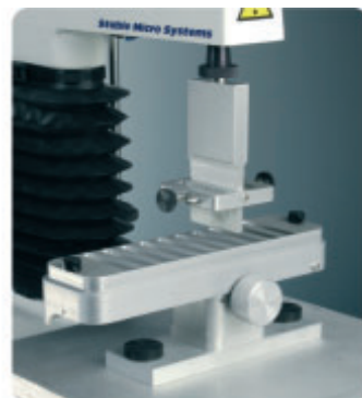
Включает пластину с несколькими щелями и зажим; предназначен для измерения силы адгезии, например, материала поверхности и клейкой ленты. (Используется с системой для определения индекса адгезии).
