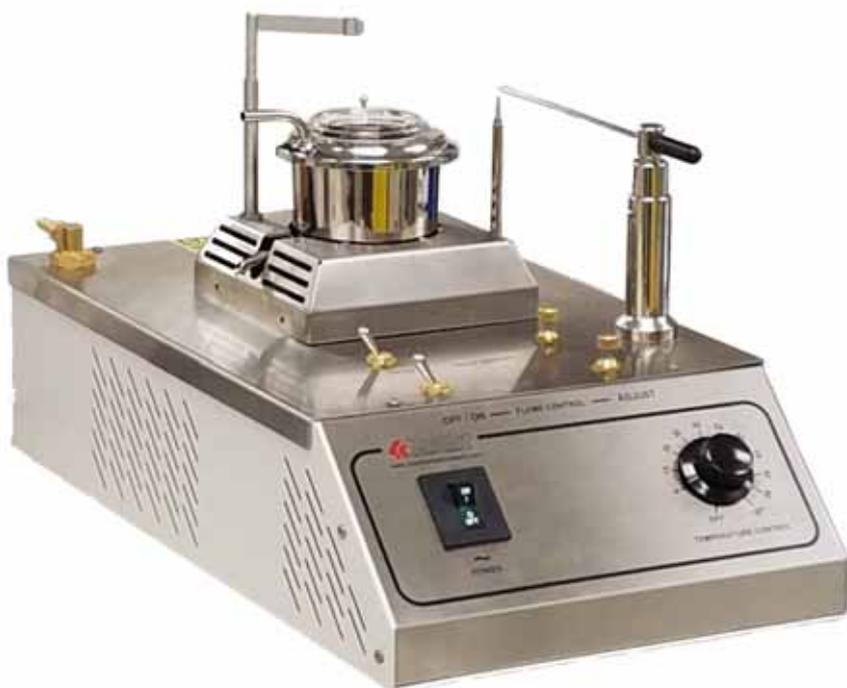
Определяет температуру вспышки жидких продуктов и разжиженных битумов в открытом тигле. Включает тигель для образца, жидкую баню с защитой от переполнения, поворачивающееся устройство зажигания с запалом и стандартным шариком, поворачивающийся держатель термометра, нагреватель и литое алюминиевое основание.
