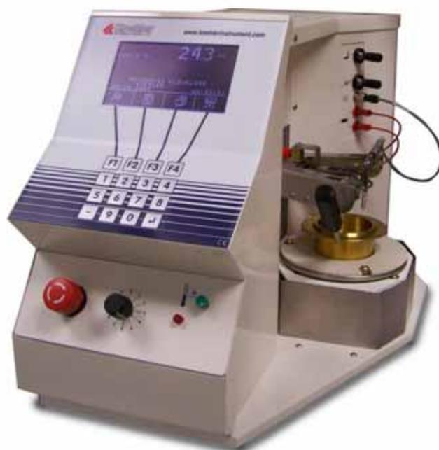
предупреждает пользователя, если первая активация устройства поджига приводит к вспышке или вспышка не обнаруживается в конце программы испытания. Если вспышка не обнаружена при температуре на 30 °С выше ожидаемой температуры вспышки или при 400 °С, испытание автоматически прерывается в целях безопасности.
