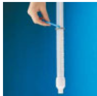
Метки глубины и подвижное кольцо-скребок
