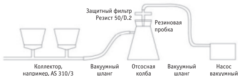
Типичная установка для вакуумной фильтрации
