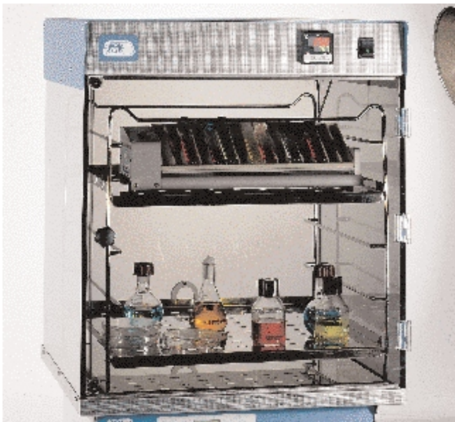
Инкубационная камера "Boxcult" кат. № 3000957 с основанием кат. № 3001172 и подставкой с 2 полками кат. № 1000973. Поставляются как дополнения.
