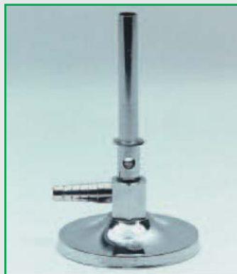
ПРОСТАЯ ГОРЕЛКА БУНЗЕНА Регулируется только поступление воздуха. Никелированная. Диаметр 11мм, высота 130 мм. Кат.№ 8.5010 для бутана/пропана 8.5011 для природного газа
