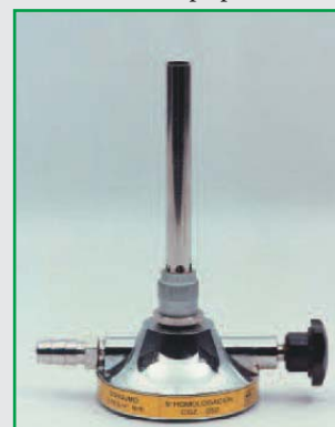
ГОРЕЛКА БУНЗЕНА Соответствует СЕ 370. Регулировка газа и воздуха. Диаметр 11 мм, высота 140 мм, номинальная мощность 0,69 кВт. Кат.№ Номин.давление 8.5014 бутан 28/37 мбар 8.5015 природ.газ 18 мбар Диаметр 13 мм, высота 170 мм, номинальная мощность 1,14 кВт. Кат.№ Номин.давление 8.5016 бутан 28/37 мбар 8.5017 природ.газ 18 мбар
