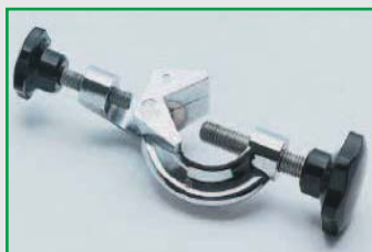
ВИНТОВОЙ ЗАЖИМ «МАКСИ» Большого диаметра. Хромированный, с зазором для стержней D до 30 мм. Второй зазор для D до 20 мм. Кат. № 15.2003
