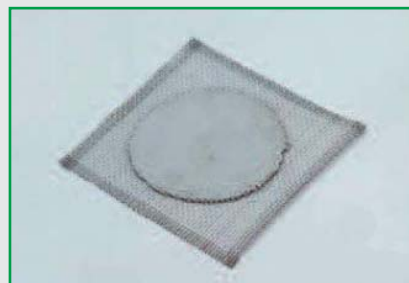
БЕЗАСБЕСТОВАЯ СЕТКА ИЗ ЖЕЛЕЗНОЙ ПРОВОЛОКИ С КЕРАМИЧЕСКИМ ВОЛОКНОМ
