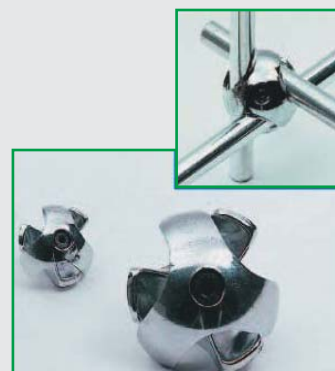
ВИНТОВОЙ ЗАЖИМ «TREVIN» DIN 12895-E16. Из хромированного дюралевого сплава. Благодаря своей прочности подходит для многоуровневых и трехмерных конструкций. Кат. № 15.2008 для диаметра 9 - 13 мм. Кат. № 15.2009 для диаметра 19 - 25 мм.
