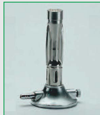
ГОРЕЛКА БУНЗЕНА С ПОСТОЯННЫМ ПЛАМЕНЕМ Постоянное пламя. Диаметр 11мм, высота 150 мм. Кат.№ 8.5032 для бутана/пропана (45/57 мбар) 8.5033 для природного газа (18/25 мбар)
