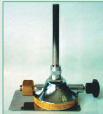
ГОРЕЛКА ДЛЯ ПРИРОДНОГО ГАЗА Соответствует СЕ 370. Регулировка поступления газа и воздуха. Подключение к газовой магистрали с помощью гайки. Диаметр 11 мм, высота 165 мм. Вес 1,6 кг. Номинальное давление 18 мбар, номинальная мощность 0,69 кВт. Кат.№ 8.5028 для природного газа
