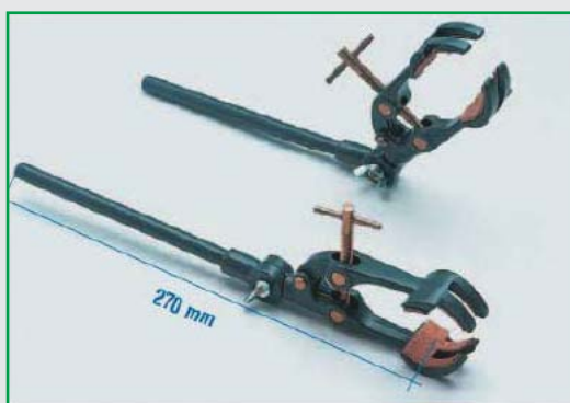
УНИВЕРСАЛЬНЫЕ ЗАЖИМЫ «ГИРОМАКС», ВРАЩАЮЩИЕСЯ Из алюминия, лапки с пробковым покрытием. С шарниром, угол вращения 180. Для Д 0 - 80 мм. Кат. № 15.2028
