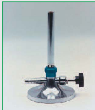
РЕГУЛИРУЕМАЯ ГОРЕЛКА БУНЗЕНА Регулируется поступление газа и воздуха. Никелированная. Диаметр 11мм, высота 140 мм. Кат.№ 8.5012 для бутана/пропана 8.5013 для природного газа
