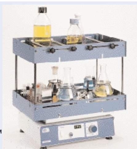
Качалка с круговым и возвратно-поступательным движением "Rotabit" в инкубационной камере "Boxcult".
