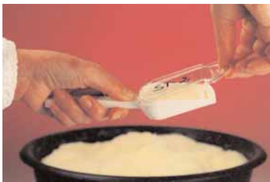
(пробоотборник 15820, 15821) Ложка полистереновая "SCOOP - P" (с крышкой).
