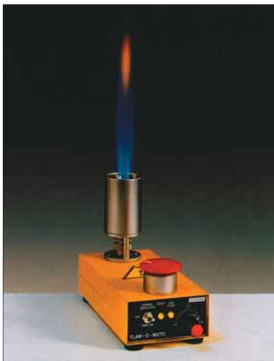
Автоматическая газовая горелка "FLAM - O - MATIC" Подвод газа по трубе. Может комплектоваться ножной педалью. Таймер от 6 до 70 секунд. Работает от 12 В. и от 220 В. В комплекте электрический адаптер.
