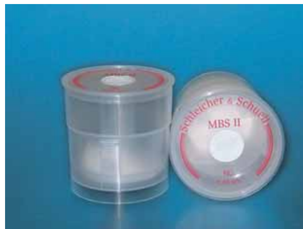
Стерильные полимерные воронки с крышкой и мембранным фильтром (0,2 и 0,45 мкр)
