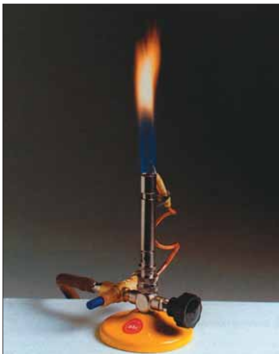
Безопасная горелка Бунзена "ДЬЯВОЛ" Особенность: имеет безопасный клапан, который предотвращает выход газа если пламени нет.
