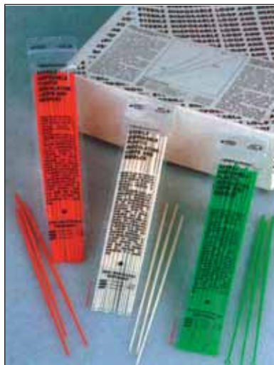
Калиброванные полимерные петли "DISPOINOC"
