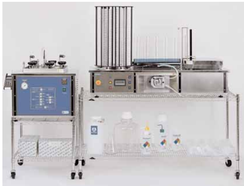
Станция "ANTARES". В состав входит: автоматическая средоварка "AGARSTER 1V", автоматический дозатор "ADD-SS", два специальных стола (или один стол ). Возможно составление специальной станции по требованию !
