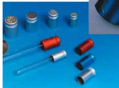
Колпачок "CAP-O-TEST" с плоской пружиной из проволоки.
