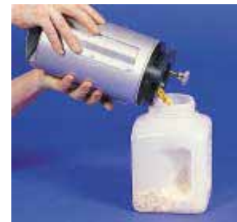
Опорожнение приемной камеры
