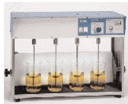
Флокулятор с вертикальной подсветкой (4 пробы).
